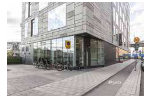
Torsgatan med skyddszon och gångbana av betongplattor och cykelbana av asfalt. Förgårdsmarken är gestaltad men en annan nyans på betongplattorna.
