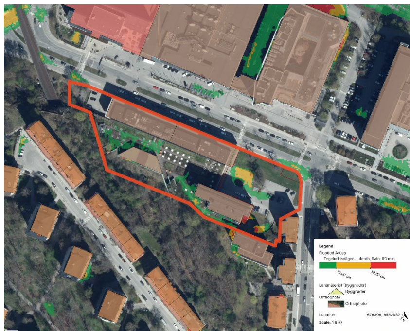
Figur 20 - Skyfallsmodellering för utredningsområdet vid 50 mm regn, modellering utförd i Scalgo Live (Niras Sweden AB 2025). Planområdet är ungefärligt markerat i rött.
