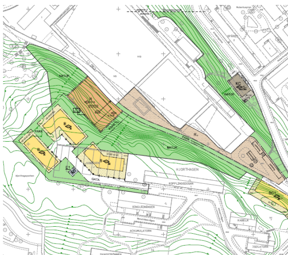
Figur 3.2: Omfattning av det framtida riksintresset Östlig förbindelse inom området. Svarta områden motsvarar anläggningsdelar ovan mark, rosa områden anläggningsdelar där tunneltak ligger djupare än 25 m under befintlig mark och röda områden anläggningsdelar där tunneltak ligger mindre än 25 m under befintlig mark. Gröna markeringar visar ungefärliga områden för planerad bebyggelse i anslutning till Östlig förbindelse, jämför med Figur 1.1. Urklipp från [6].
