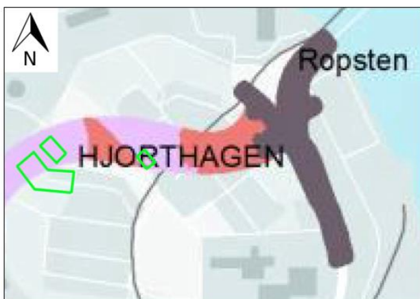
Figur 3.2: Omfattning av det framtida riksintresset Östlig förbindelse inom området. Svarta områden motsvarar anläggningsdelar ovan mark, rosa områden anläggningsdelar där tunneltak ligger djupare än 25 m under befintlig mark och röda områden anläggningsdelar där tunneltak ligger mindre än 25 m under befintlig mark. Gröna markeringar visar ungefärliga områden för planerad bebyggelse i anslutning till Östlig förbindelse, jämför med Figur 1.1. Urklipp från [6].
