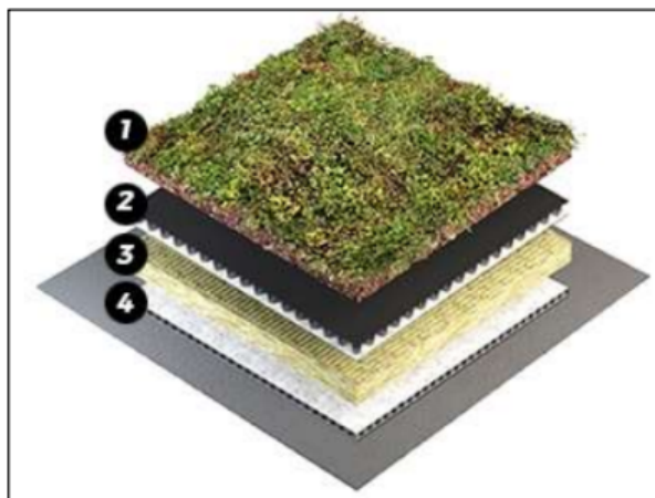
Exempel på uppbyggnad av sedumtak med stenullsskiva.
