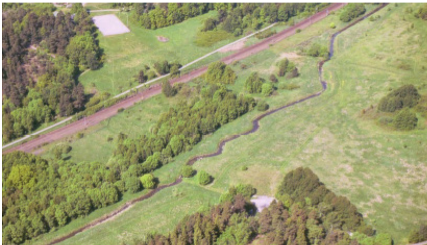
Restaurering av uträtat dike till meandrande vattendrag. Foto: Miljöförvaltningen Stockholms stad
