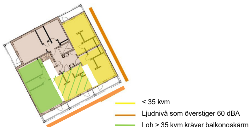
Figur 27. Förslag till planlösningar för punkthusets typvåning, plan 1-8. De lägenheter som på de flesta våningarna behöver ges en yta på högst 35 kvadratmeter eller utförs med bullerreducerande balkongskärm är markerade. Mittenlägenheten mot söder kan inordnas med den större lägenheten i sydväst om balkong utförs med två bullerreducerande balkongskärmar som indikerat i bilden.
