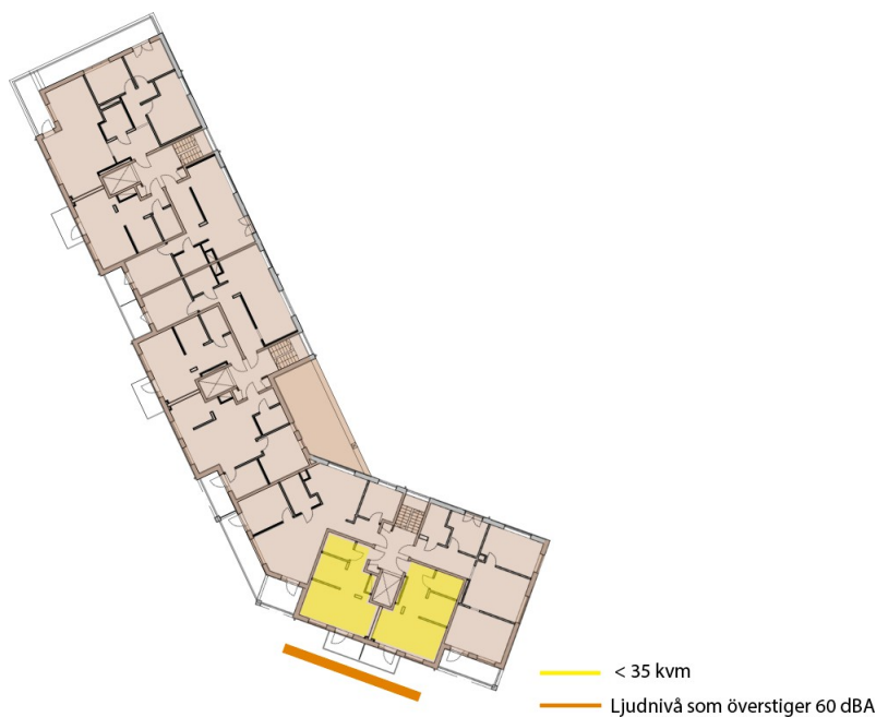
Figur 24. Förslag till planlösningar för lamellhuset mot spåret. De lägenheter som behöver utformas med bulleranpassade planlösningar på översta våningen är markerade. På de två våningarna under den översta våningen behöver bara den högra markerade lägenheten vara under 35 kvm.
