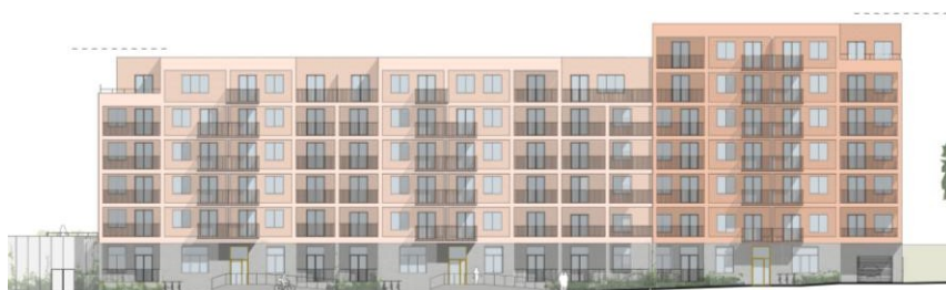
Figur 11 – Möjlig fasad mot väster längs ny angöringsgata med angiven maximal nockhöjd (streckad linje). Begränsade teknikutrymmen kan därutöver tillkomma på byggnadernas tak. (FLOR arkitektur, 2024).
