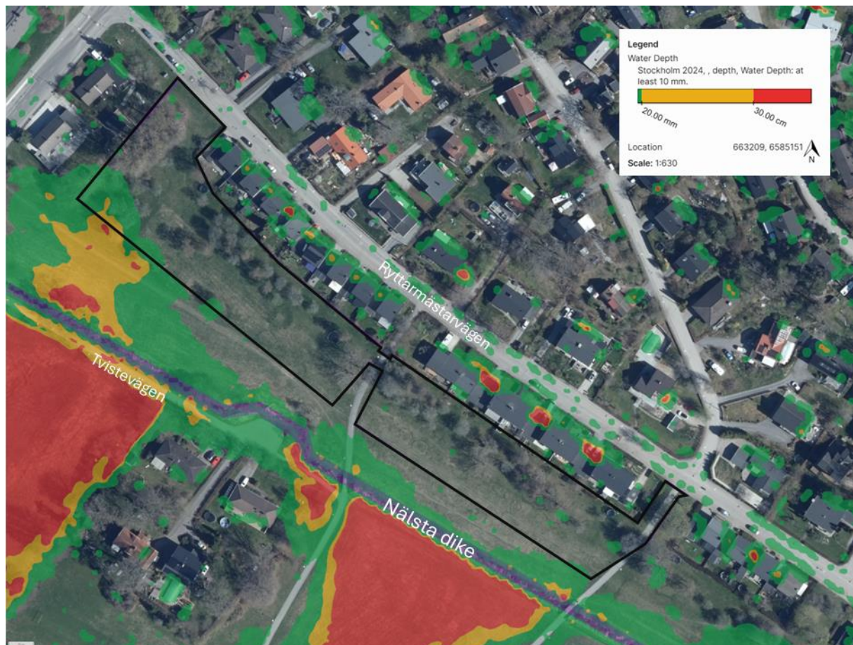
Figur 12 Det maximala djupet under simuleringstiden vid skyfall enligt Stockholms stads skyfallskartering (preliminärt resultat, 2024). Föreslagen kvartermark (utredningsområdet) markerad med en svart linje.
