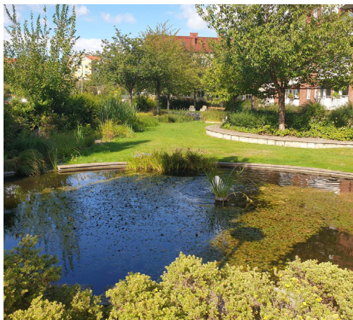
Figur 23 Dagvattendamm (Augustenborg). Fördröjningsvolymen är den volym ovanför permanent vattenspiegel, i det här fallet ungefär upp till planteringen upp till höger i bild
