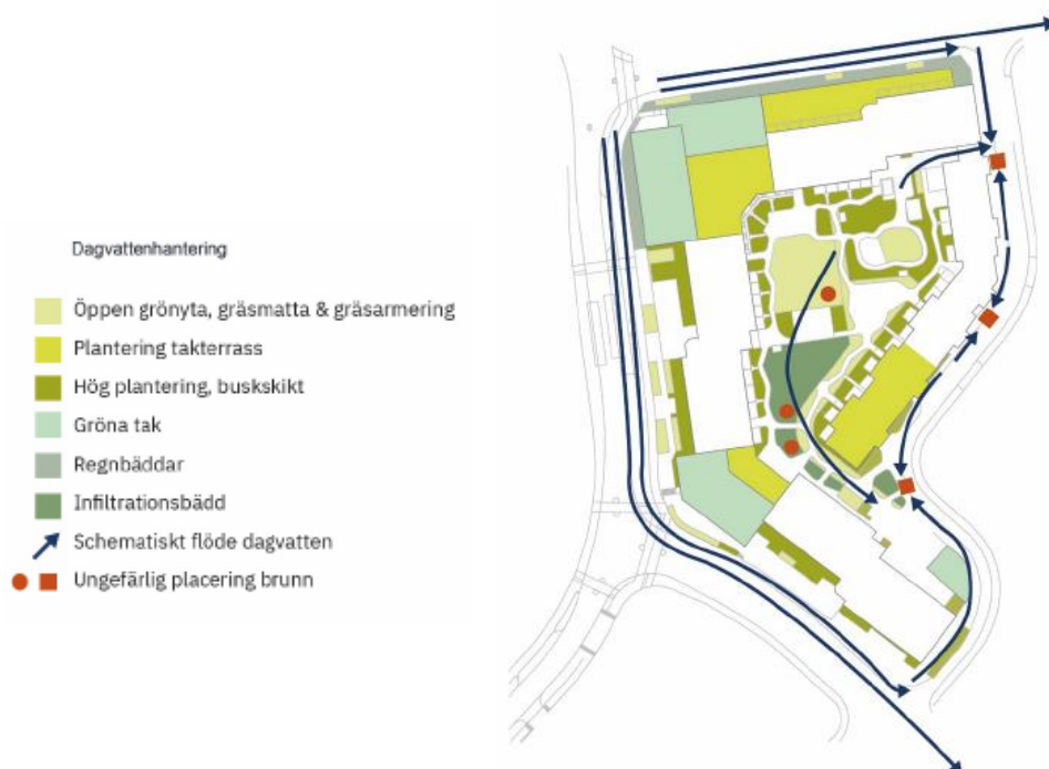
Översikt som visar lösningar till dagvattenhantering (Bild: Kragh Berglund, Structor).
