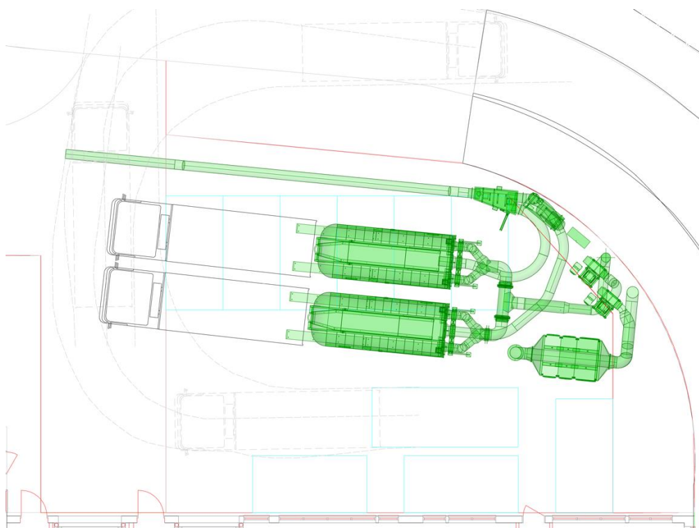
Fig. 2 exempel stationärt sopsugsystem med maskineri, inritat vid föreslagen plats vid Hus 8, Källa: Logiwaste
