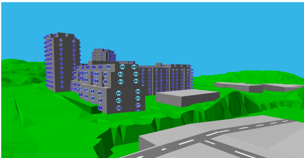
Figur 8 Totalt ljud från körning med fordon inne på Mathems område att klassas som industribuller, värsta fallet. Resultatet domineras fullständigt av distributionsbilarnas bidrag.
