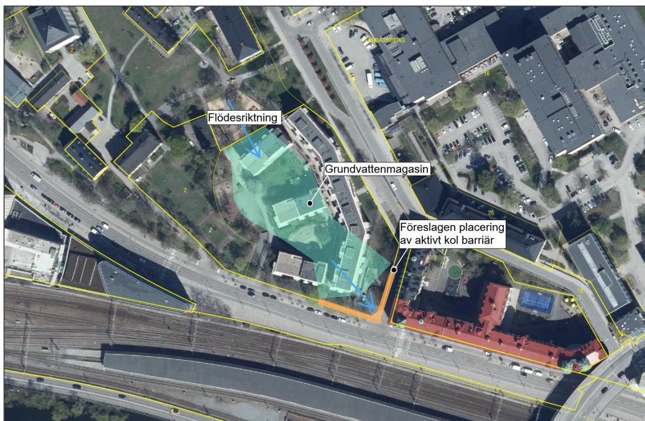
Figur 1: Konceptuell åtgärdsmodell som visar föreslagen placering av aktivt kol barriären vid Silverskopian 3. Område för grundvattenmagasin och flödesriktning efter Sweco (2024). Barriären (orange färg) är lokaliserad nedströms i flödesriktningen för att minska spridningen av PFAS till Mälaren. Bakgrundskartan ©Lantmäteriet.
