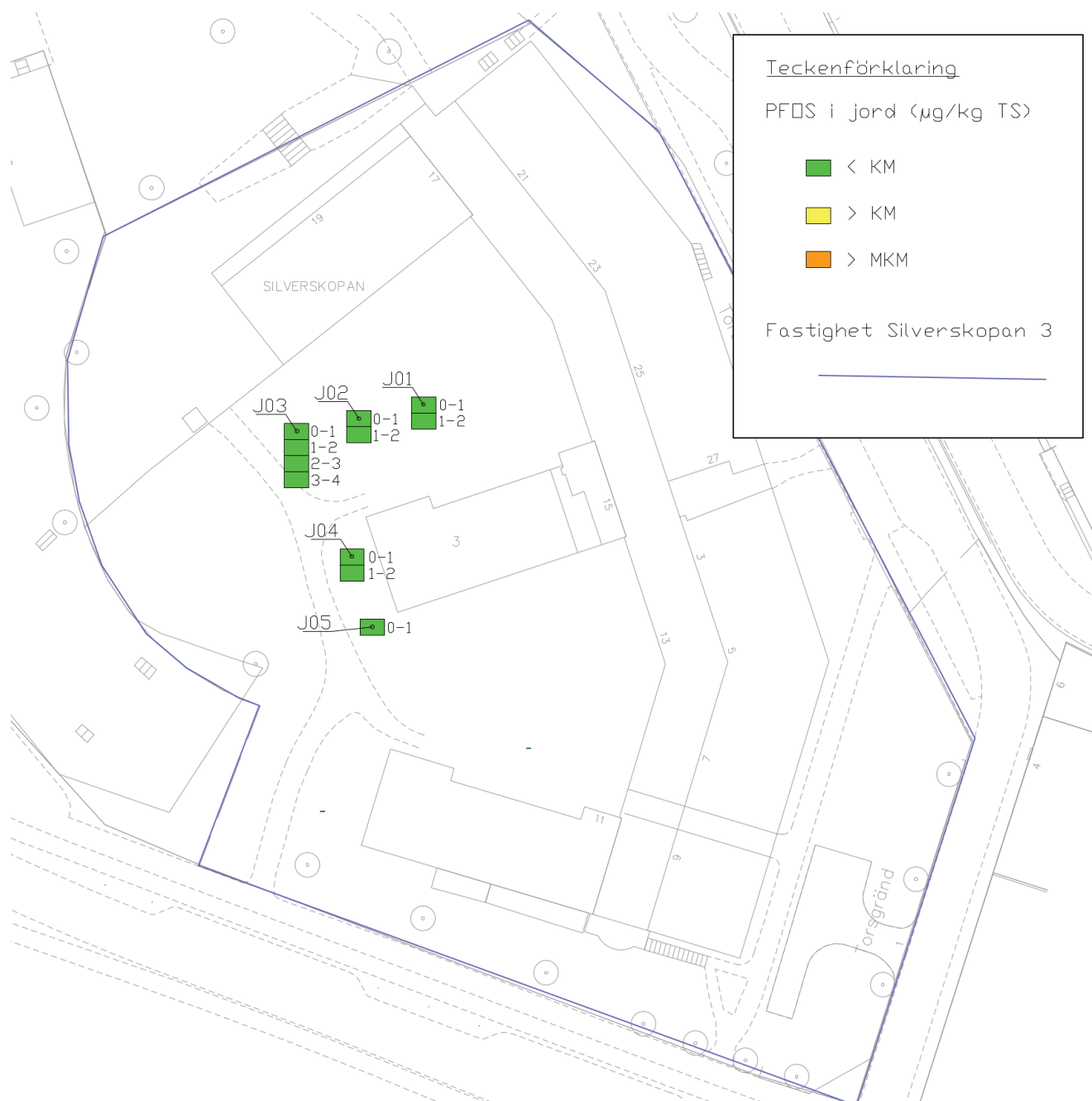
Figur 5: Uppmätta halter av PFOS (µg/kg TS) i jord inom fastigheten Silverkopan 3 i Stockholm. Kvadraterna visar den vertikala fördelningen i varje provpunkt där varje kvadrat motsvarar ett analyserat prov. Den översta kvadraten presenterar positionen för provuttaget. Kvadraterna har färgkodats utifrån uppmätt halt i en färgskala som sträcker sig från grönt (<KM), gult (>KM-≤MKM) till orange (>MKM). Provdjupet (m u.my.) presenteras vänster om kvadraterna.
