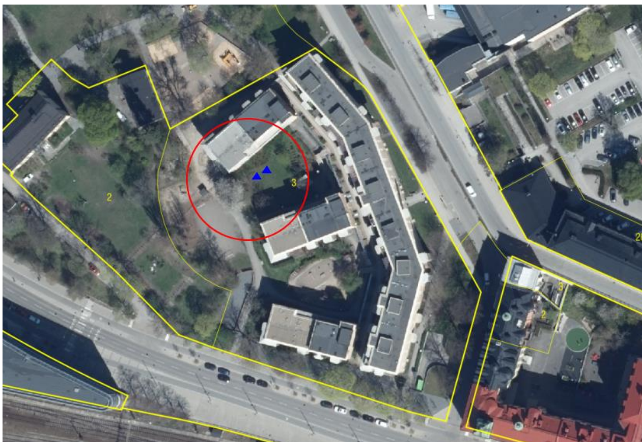
Figur 1: Ortofoto över fastigheten Silverskopan 3 i Stockholm (©Lantmäteriet 2024). Röda ringen visar området för gasklockans grundmur. Blåa trianglar visar tidigare installerade grundvattenrör benämnda 21PE_GV01 och 21PE_GV01grund (PE, 2022a).
