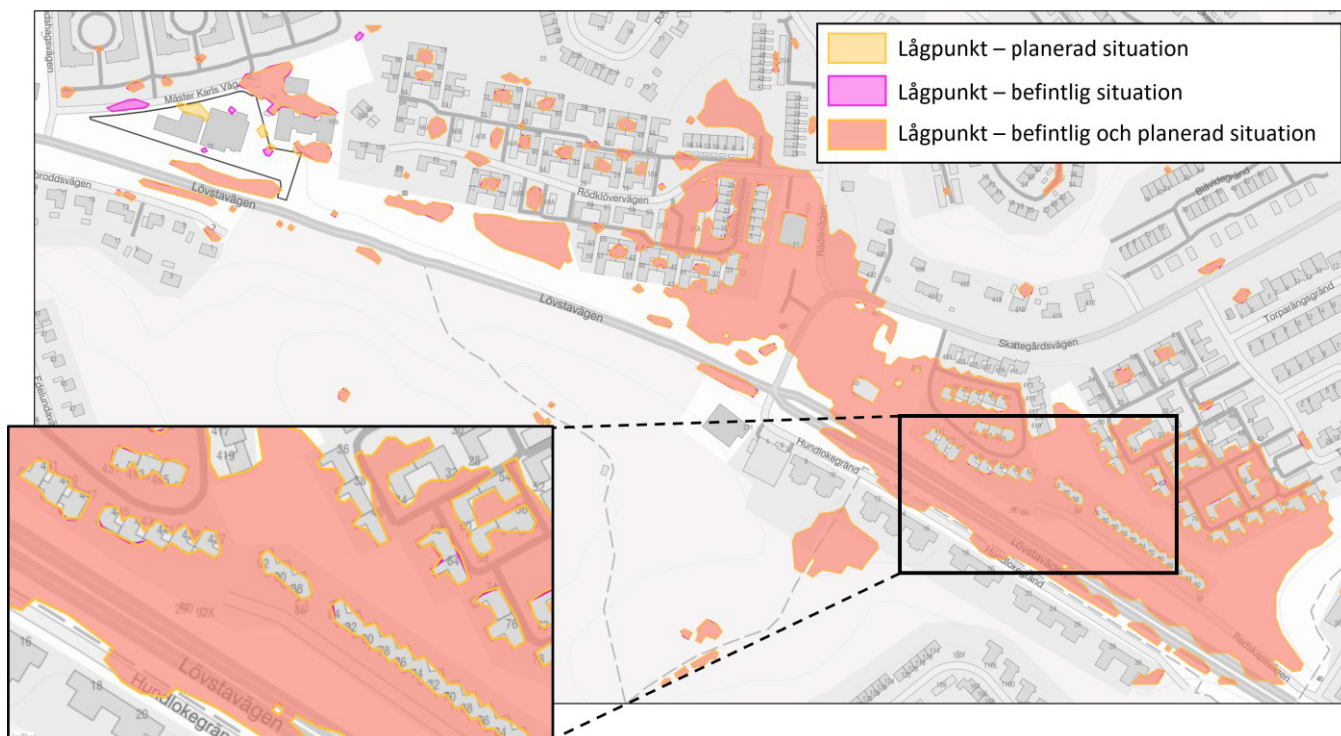
Figur 27. Skillnad i utbredning av lågpunkter mellan befintlig och planerad situation. Planområdet är markerat i svart. Lågpunkterna är begränsade till ett vattendjup på minst 5 cm.
