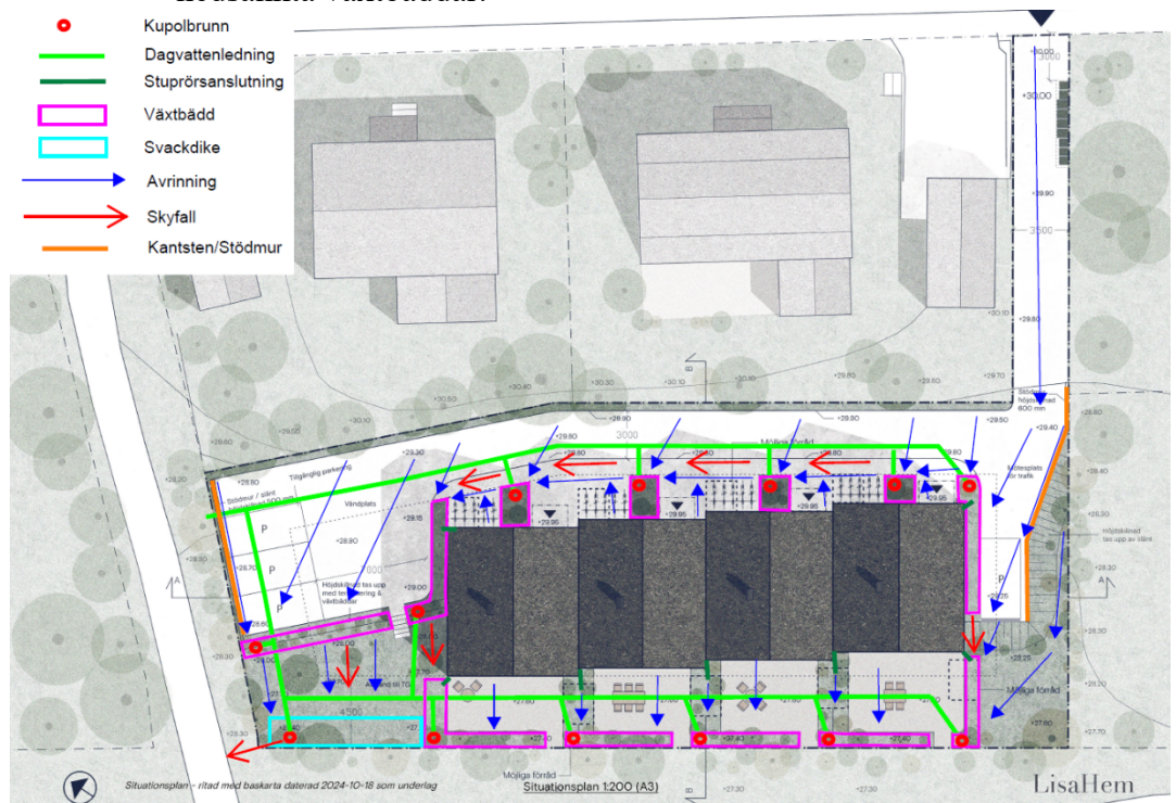
Bilden visar principlösning för dagvattenhantering. Illustration av Structor och Studio Rå.
