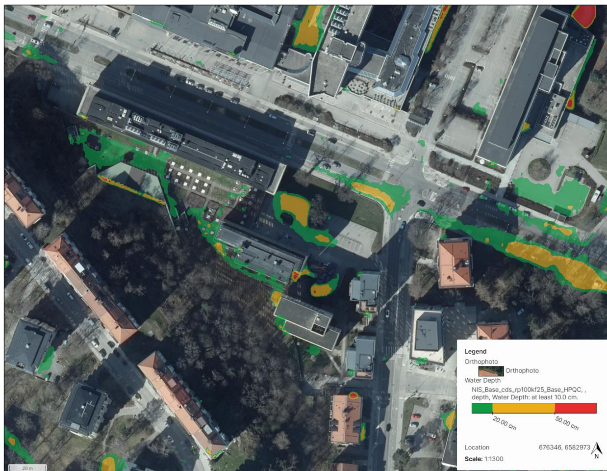
Figur 15 Skyfallskartering från Stockholms stad 2024, som visar på maxdjupet vid skyfall (klimatkompenserat 100-årsregn).
