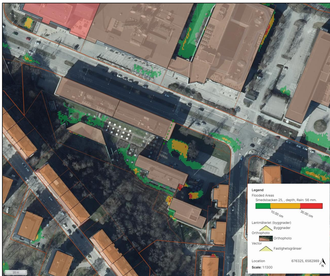
Figur 12 Skyfallsmodellering för Smedsbacken 25 vid 50 mm regn, modellering utförd i SCALGO Live. Vattendjup för stående vatten visas i färgskala grön, gul och röd.
