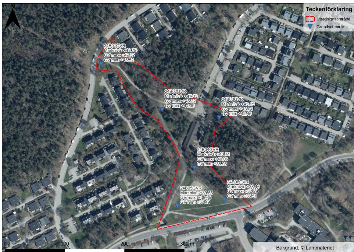
Figur 5. Ortofoto över området med grundvattenrören placering och uppmätta grundvattennivåer.
