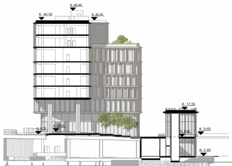
Sektion genom huvudbyggnad (t v) och paviljong (t h) med tunneln samt utrymmen för teknik, leverans och stödfunktioner under mark (Dorte Mandrup 2024).
