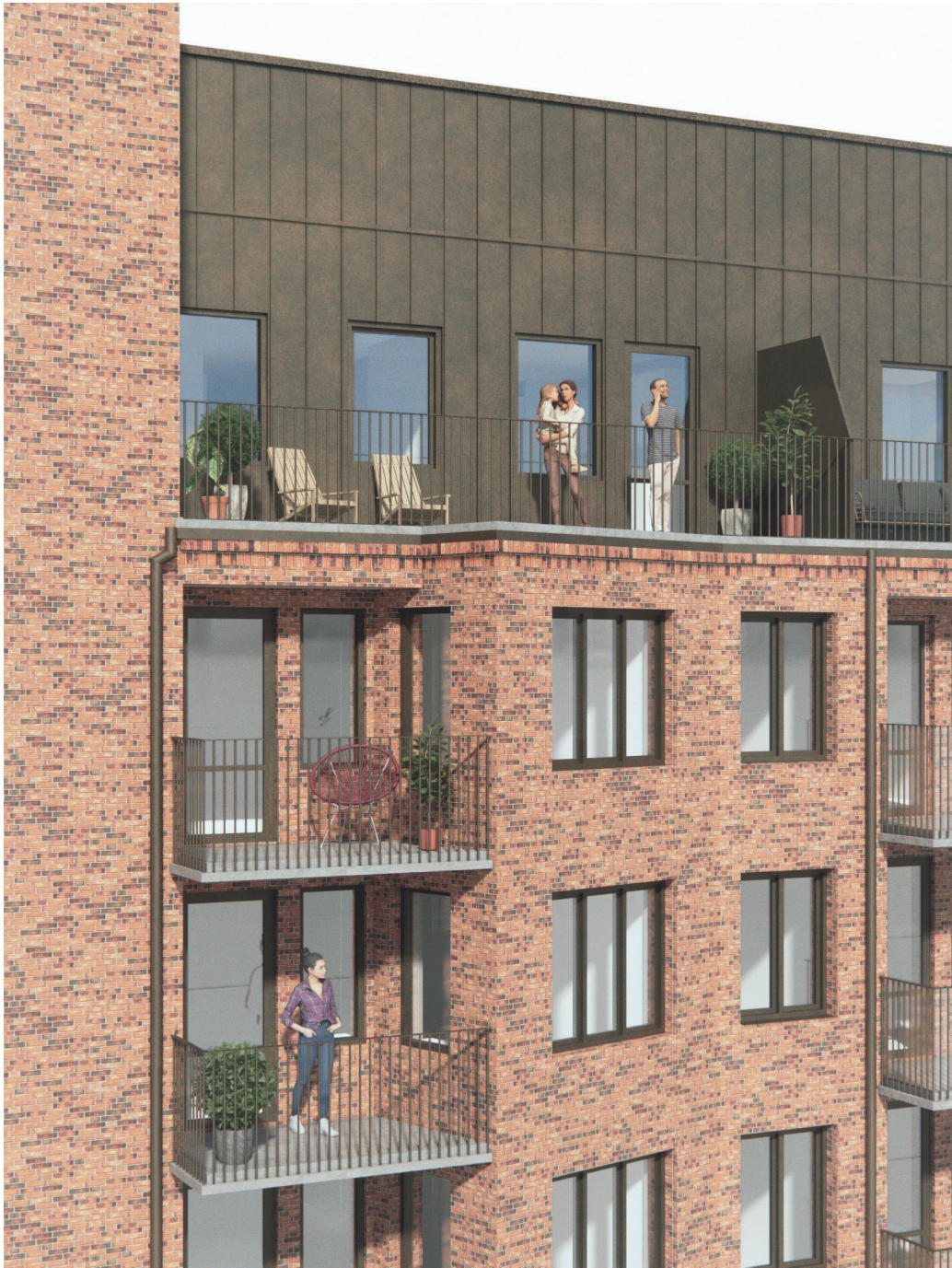
Indragen våning med plåtfasad i samma kulör som fönster, räcken och plåtdetaljer. Tegelfris med skuggeffekt som avslut för terrasskant.
