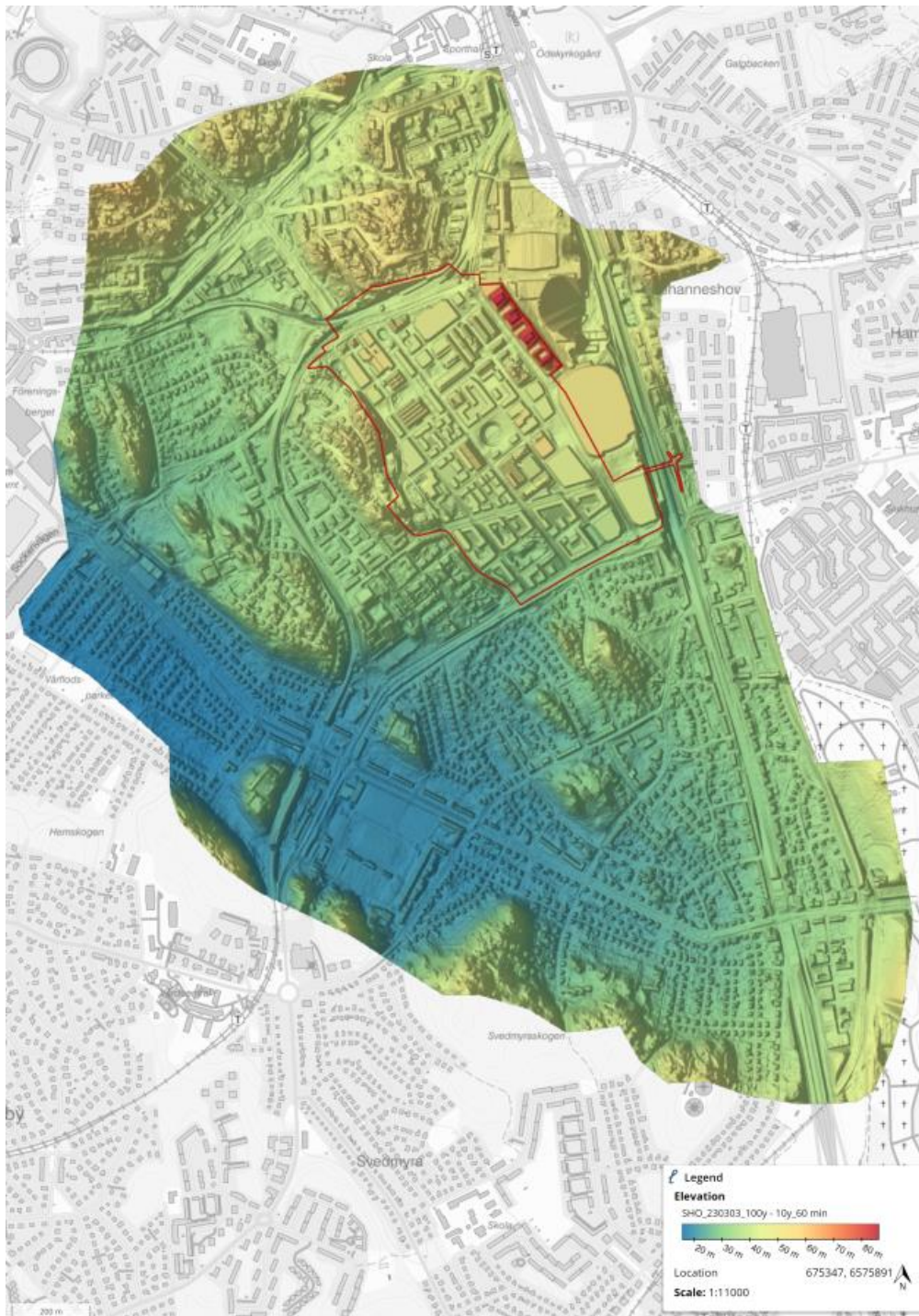
Figur 6 Höjdmodell utnyttjad i skyfallsmodellen för den framtida situationen. Slakthusområdet markerat med röd linje. Modellområdet för befintlig situation täcker samma yta.
