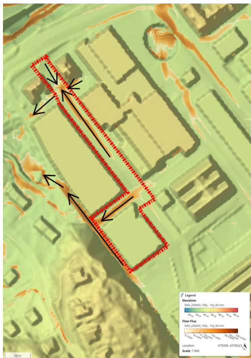
Figur 14 Flödesvägar inom Dp 2c. Tjocka, svarta pilar visar på flödesriktning. Nyanser av orange indikerar olika storlekar på flödet, större flöden vid mörk nyans.
