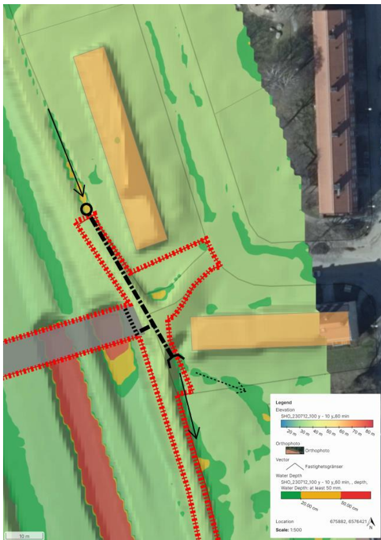
Figur 14. Maxvattendjup vid framtida situation inom och runt om detaljplanegränsen för Dp 4a på Blåsutsidan av Nynäsvägen. Vattendjup enligt följande; grön = 0,05-0,2 m, gul = 0,2-0,5 m, röd = >0,5 m. I Figuren redovisas även flödespilar i heldraget och sekundär flödesväg i streckad pil. Tjocka svarta streck indikerar dagvattenrumma och linjeavvattningsrännor. Svaga gråa linjer redovisar befintliga fastighetsgränser.
