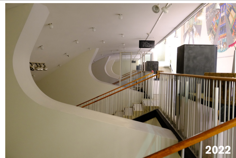
Den stora förändringen är att bärande betongbågar målats vita och att infällda spotlights ersatts med utanpåliggande armaturer. Ursprungliga räcken är bevarade.
