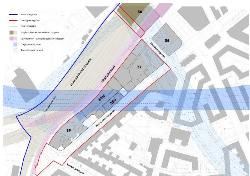
Bild 8 - Planerad bebyggelse i förhållande till Citybanans tunnlar
