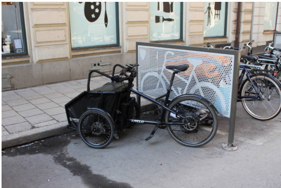
Figur 11. Cykelparkering måste finnas för olika typer av cyklar, så som exempelvis lådcyklar. I bilden ovan har en lådcykel ställt sig utanför cykelstället som endast är dimensionerat för normalbreda cyklar.
