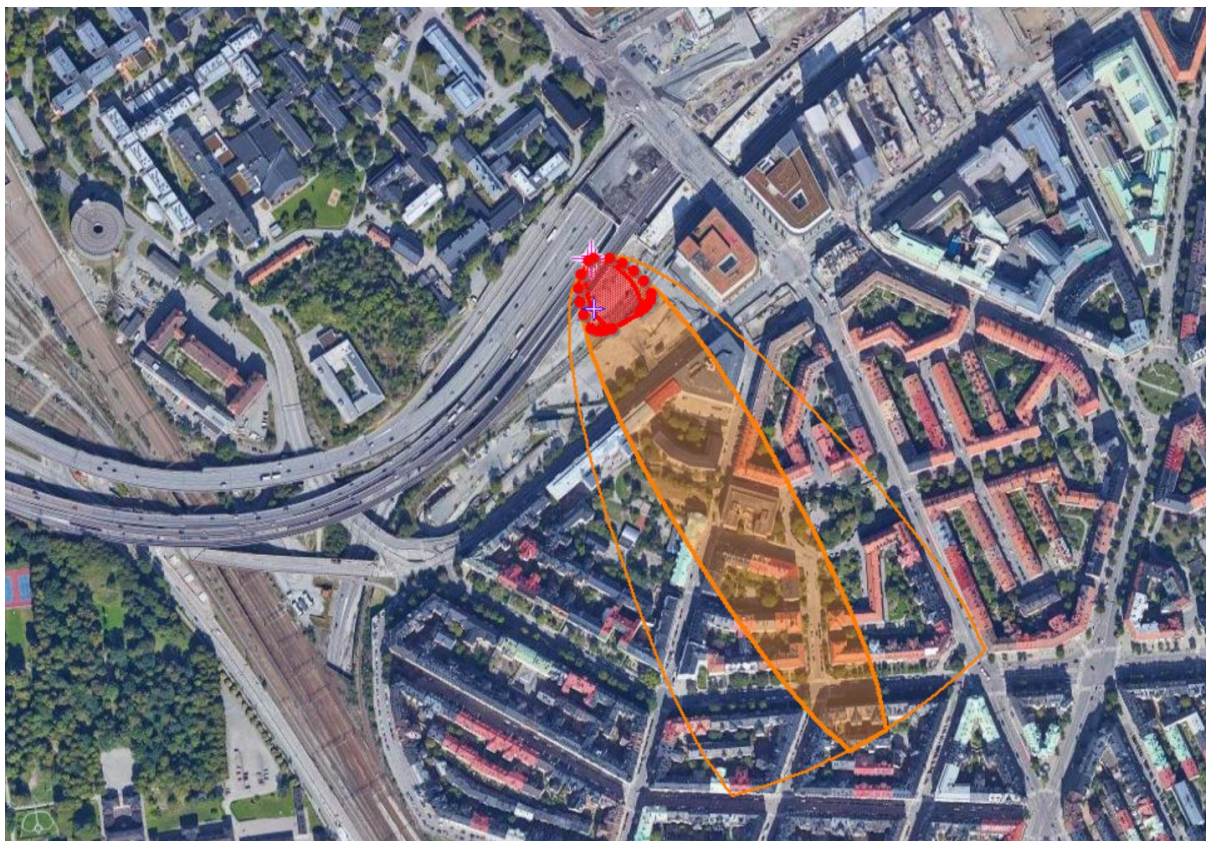
Figur 21. Resultat från utförda spridningsberäkningar av ett utsläpp av tryckkondenserad ammoniak, brott på rör (medelstort utsläpp). Röd zon (ca. 40 x 70 m) åskådliggör ytor utomhus där människor efter 5 minuters exponering kan omkomma medan orange zon ca. (90 x 540 m) åskådliggör ytor utomhus där människor efter 5 minuters exponering kan förväntas behöva akut vård.
