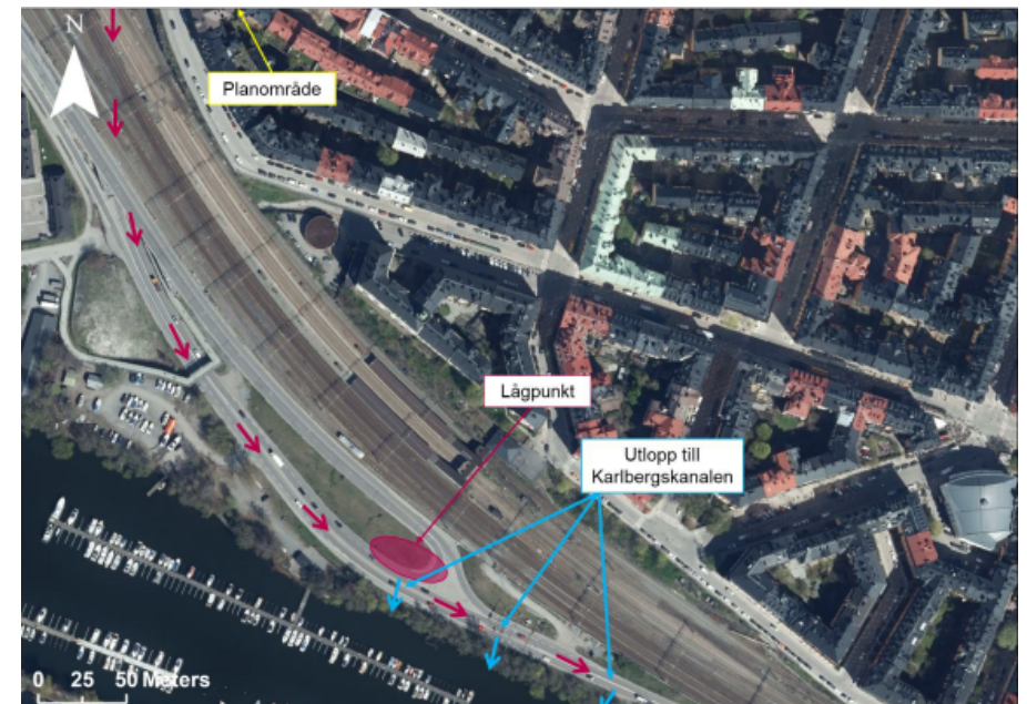
Figur 40. Delar av vattnet från planområdet rinner söderut på Klarastrandsleden innan det når Karlbergskanalen via släpp i kantstenen. En del av vattnet ansamlas i en lågpunkt vid påfarten från Pampaslänken. Lågpunktens maximala vattendjup är ca 30 cm. (Norconsult, 2024)
