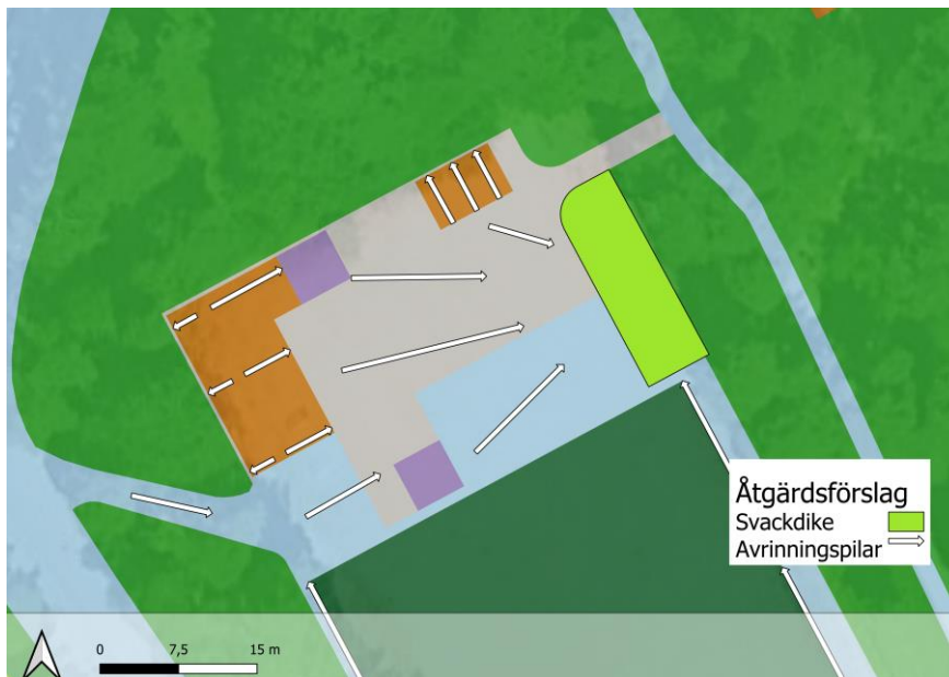
Figur 25. Förslag dagvattenhantering för tak, asfalt, grusyta och parkering. Pilar visar avrinning. Mindre del av takdagvattnet leds ut på befintlig naturmark.
