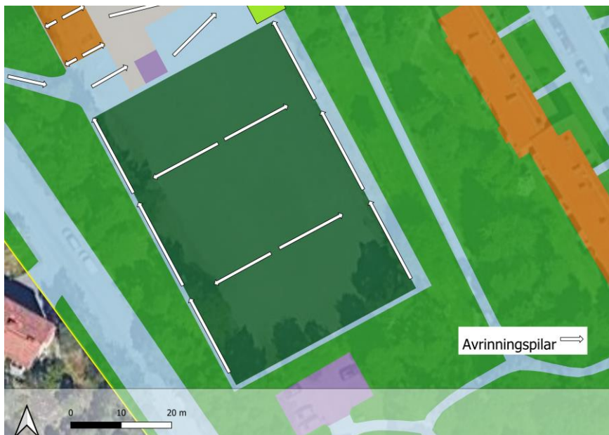
Figur 22. Skiss över konstgräsplanen i det fall den bommeras. Lågstråk bör skapas längs med långsidorna. Brunnar placeras i lågstråk samt längs med norra kortsidan, exempelvis som i Figur 21. Om planen anläggs med sidolut åt öster sker avrinning enbart ditåt och brunnar i väster lågstråk kan eventuellt utgå.
