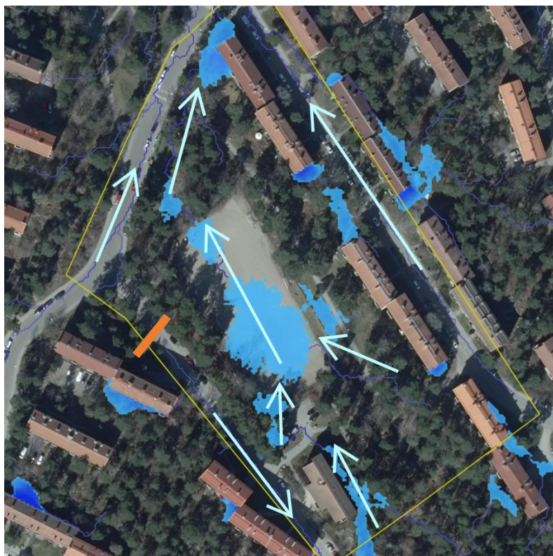
Figur 12. Bild som visar avrinning (blå pilar) inom planområdet (gul polygon). Ungefärlig ytvattendelare i orange (Bild: SCALGO Live)
