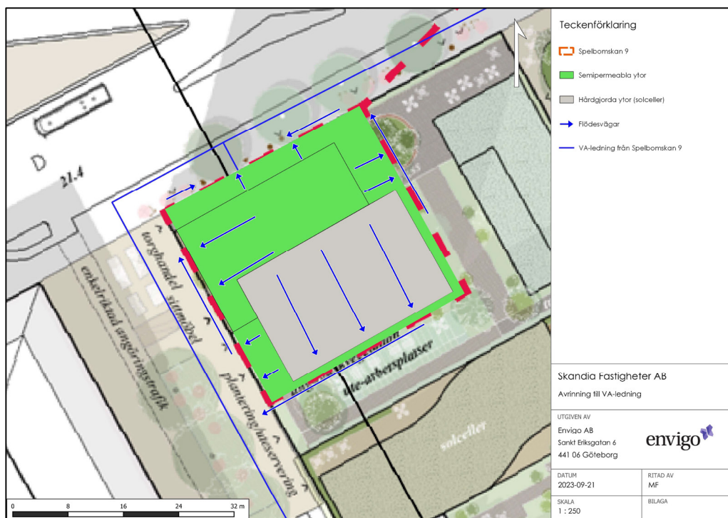
Figur 16: Dagvattenhantering inkl VA-ledning för fastigheten Spelbomskan 9. Se även Figur 11.
