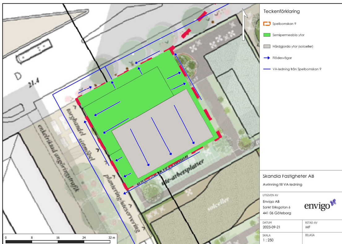
Figur 18: Dagvattenhantering inkl VA-ledningar för fastigheten Spelbomskan 9. Se även Figur 11.
