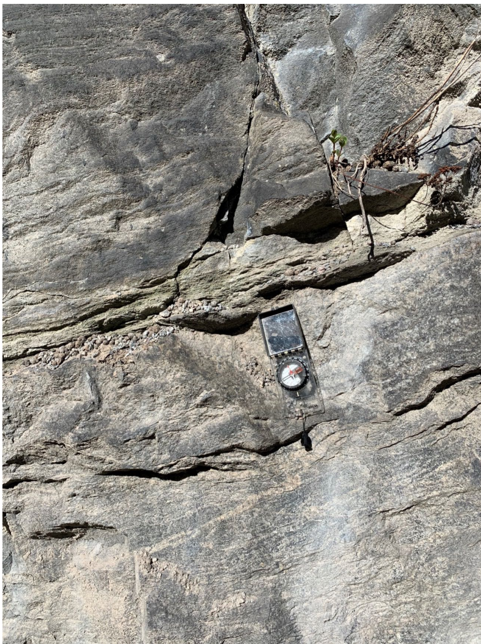
Figur 13: Centrala delen av slänten. Ett lerslag som följer foliationen.
