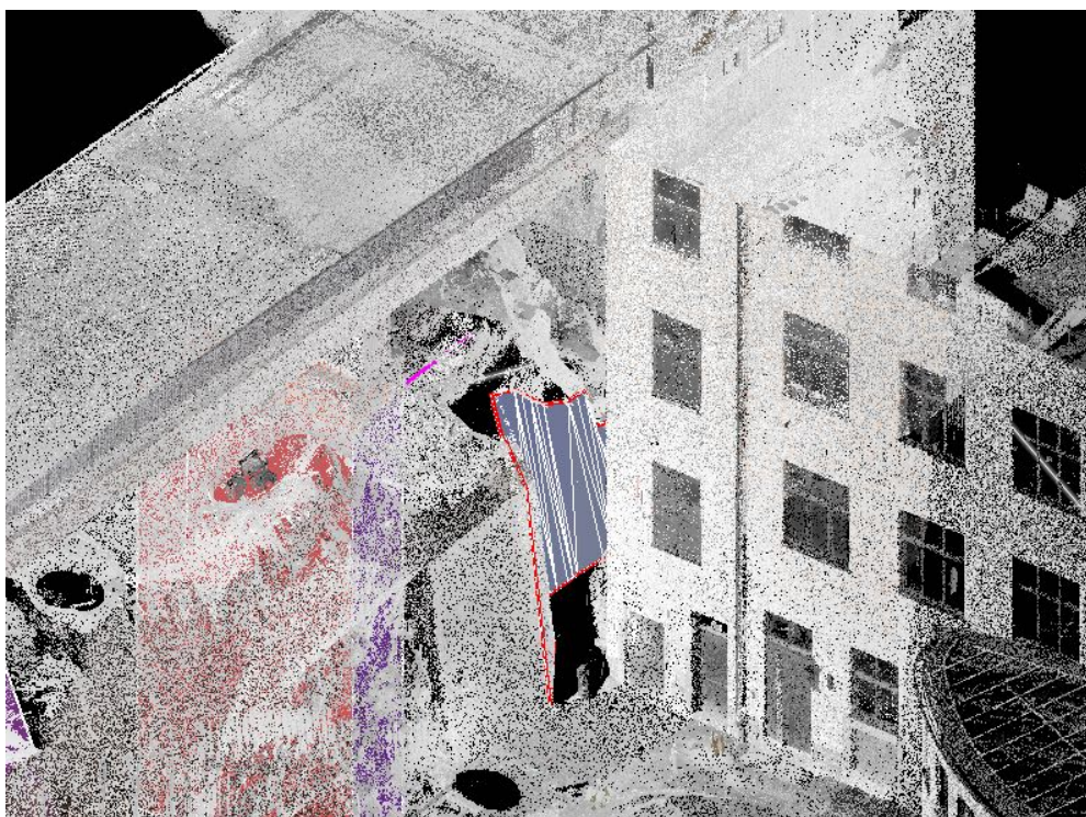
Figur 7: Den förväntade schaktytan inritad i blått i den laserskannade modellen. Restriktionsvolymen för det närmaste brostödet kan skönjas till vänster.
