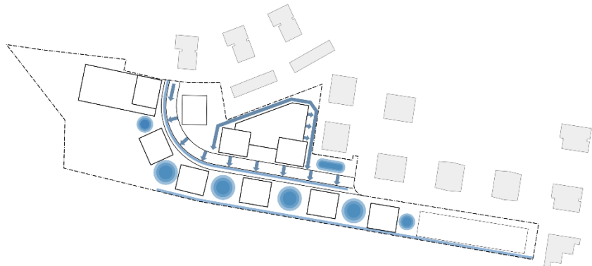
Figur 19. Principer för dagvattenhantering. Blå pilar visar rinnvägar för vatten och blå ytor visar ytor där vattnet fördröjs och renas. (Strategisk arkitektur, 2024).
