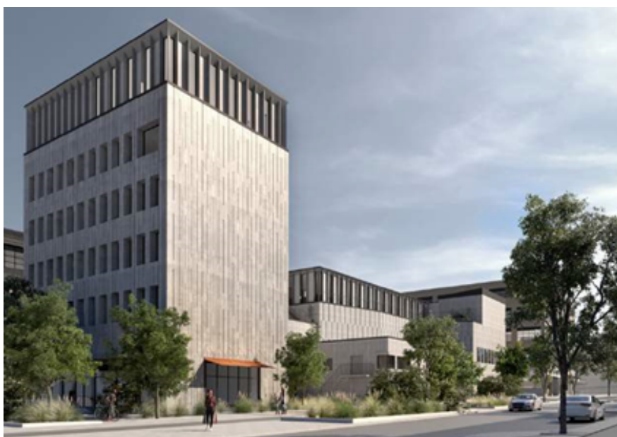
Förslag på om- och tillbyggnad av bevarad del av Lintaverken sett från huvudgatan. Det gamla jetmotorprovhuset föreslås att bevaras och anpassas för ny verksamhet genom håltagning för fönster i ena fasaden och påbyggd våning i avvikande material. Bild: DinellJohansson
