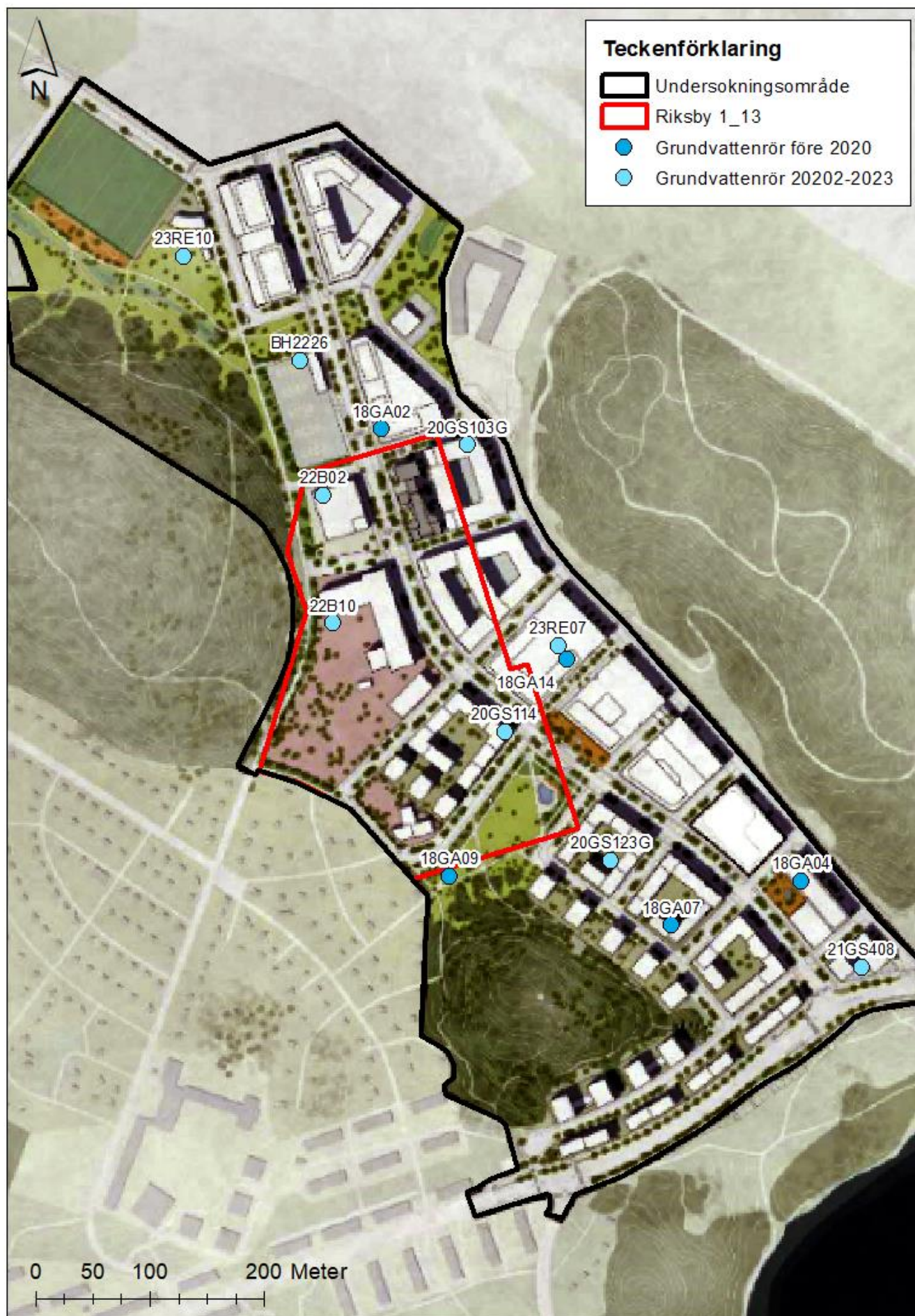
Figur 3-Situationsplan med samtliga grundvattenrör som använts vid grundvattenprovtagningar mellan 2020-2023.
