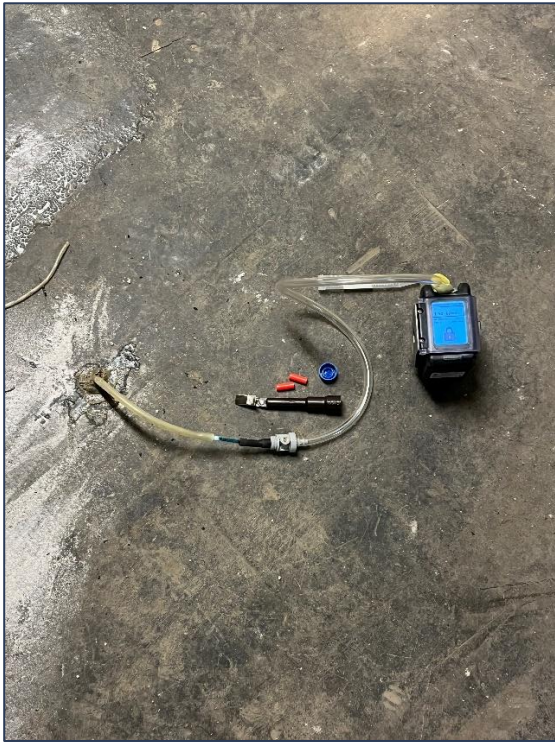
Figur 1. Porgasprovtagning genom aktiv pumpning genom ett kolfilter.
