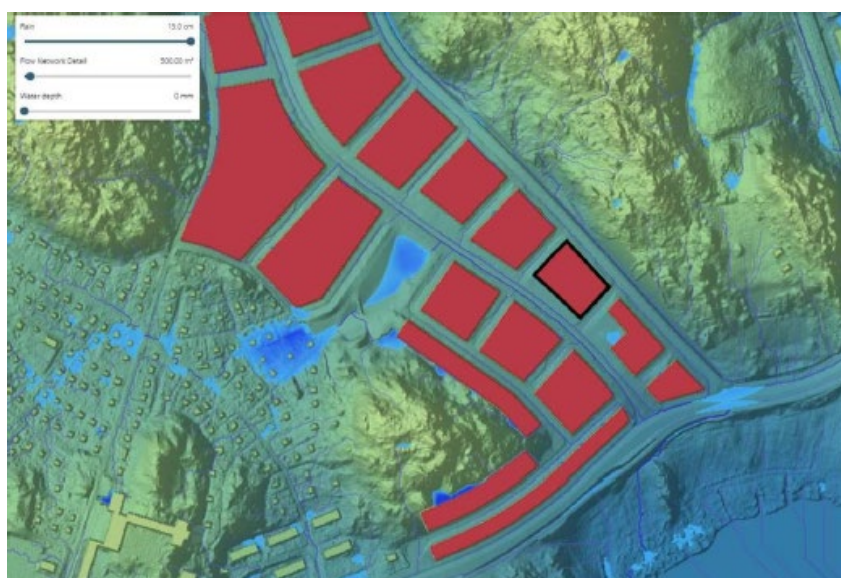
Figur 21. Skyfallsvägar efter planerad höjdsättning i omgivande detaljplan. Svart markering visar planområdet (Sweco, 2021).
