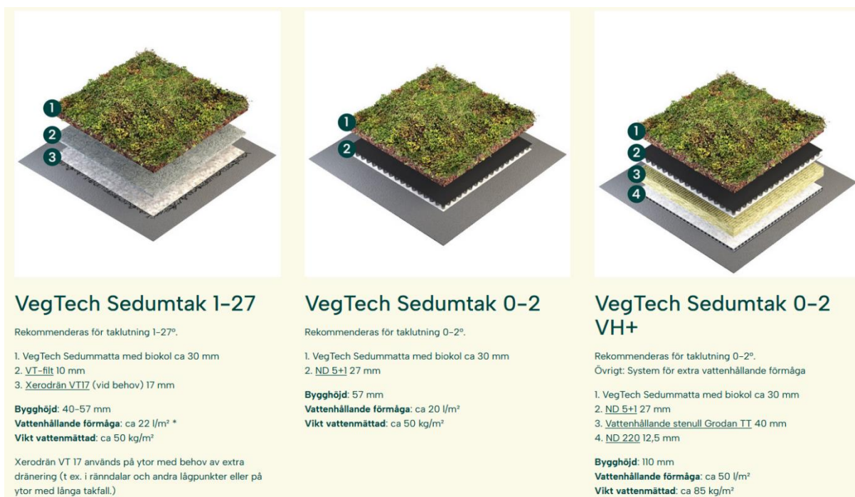
Figur 5-2. Exempel uppbyggnader VegTech Sedumtak vid olika taklutningar 9 .
