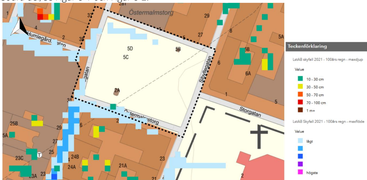
Figur 8-1. Länsstyrelsens skyfallskartering där flödesvägar redovisas med blått och stående vatten på markytan redovisas med grönt, gult och rött. Utredningsområdet markerat med svart streckad linje.
