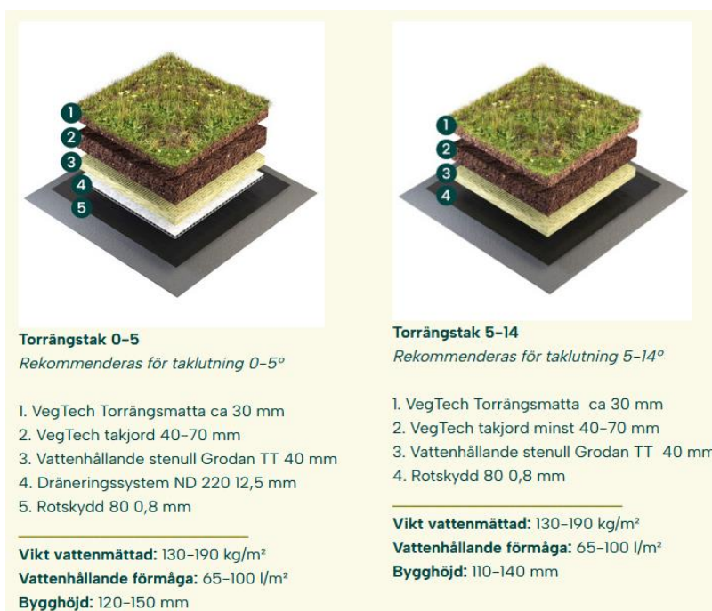
Figur 5-3. Exempel uppbyggnader VegTech Torrängstak vid olika taklutningar 10 .
