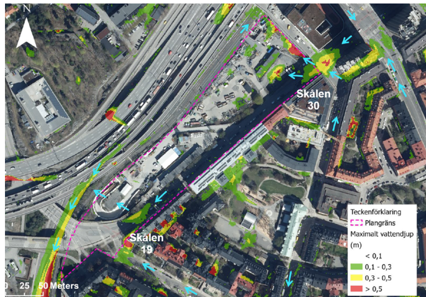
Maximalt vattendjup vid ett 100-årsregn för nollalternativ, med principiella flödesvägar redovisade med ljusblå pilar. Vatten samlas i lågpunkter och invid fastigheterna Skålen 19 och 30. Källa: Norconsult, 2024
