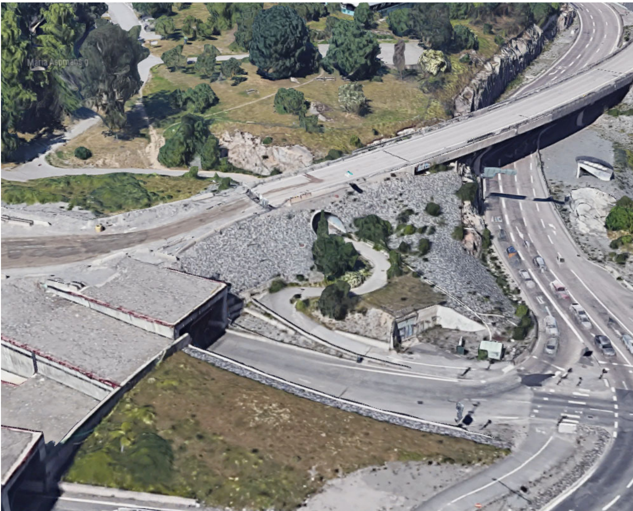
BILD AV BEFINTLIG STÖDMUR OCH GC-TUNNEL SOM RIVS
