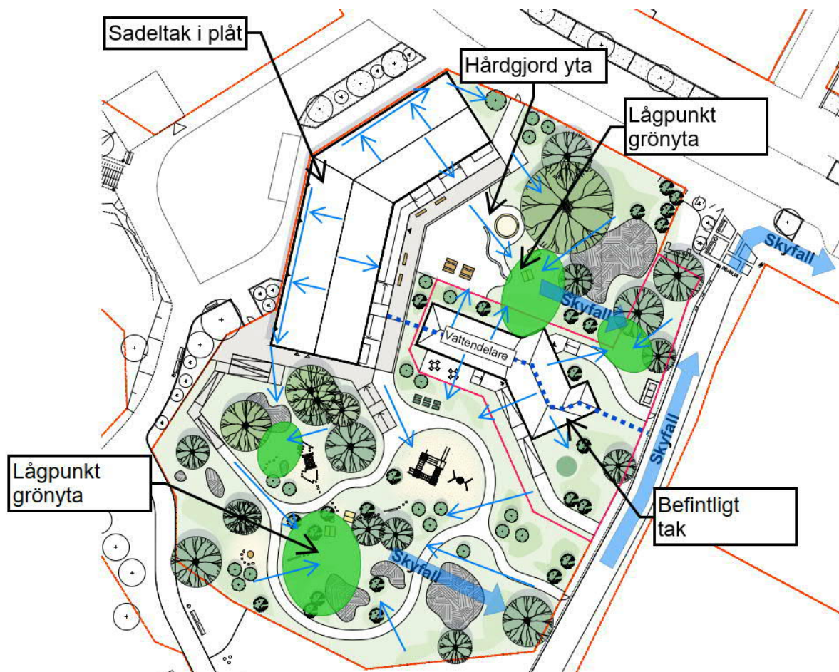
Figur 4. Förskolan Villan. Systemlösning dagvattenhantering. Föreslagna lågpunkter redovisas schematiskt som gröna ovaler. Den lokala vattendelaren redovisas, varifrån avrinning bedöms ske norr- respektive söderut. Flödesriktning för dagvatten illustreras med tunna blå pilar och flödesvägar vid skylfall illustreras med stora pilar. På det planerade taket redovisas föreslagen avrinningsriktning via stuprör och utkastare.
