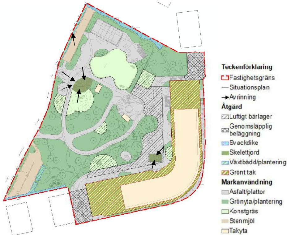
Figur 15. Hårdgjorda ytor i nordväst leds mot plantering med skelettjord. Pilar visar avledning.
