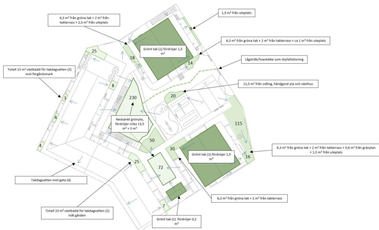
Figur 26. Översiktlig skiss över tillgängliga ytor (gröna ytor med den totala ytan i kvadratmeter markerat i svart) samt vilket vatten som rinner till ytan för anslutningspunkt C. Skillnaden i färgade ytor indikerar vilket vatten som omhändertas i vilken dagvattenlösning. Flödespilar i blått.
