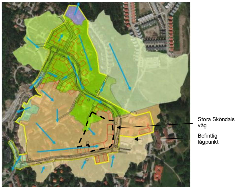
Figur 10. Ungefärliga ytliga avrinningsområden (färglagda områden) samt rinnvägar (ljusblå pilar) för etapp 2a efter exploatering. Bild från den övergripande dagvattenutredningen (WSP, daterad 2020-12-01). Skolfastigheten markerad i svart.
