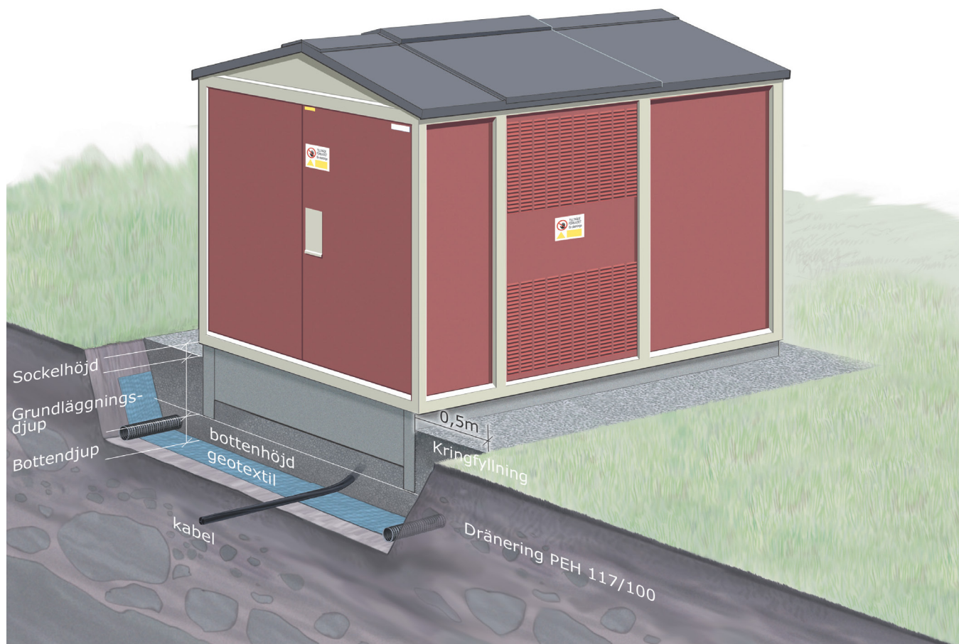
Grundläggning för stationer < 12 ton
