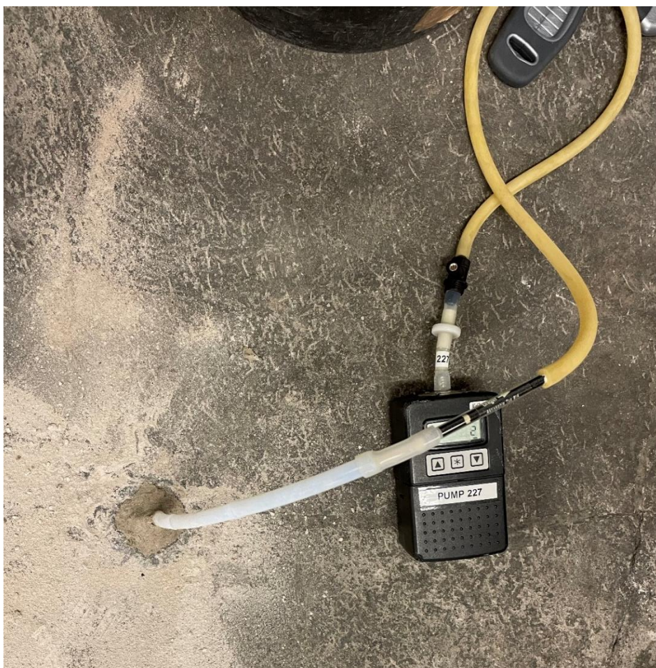
Figur 3. Uppställning av provtagningsutrustning vid provtagning i punkt 23T01, belägen på plan 4 i garagedelen. Fältanalys utfördes direkt ned i slangen som går ned i hålet, runt slangen har bentonit använts för att täta hålet. Foto: Tyréns, 2023-08-31
