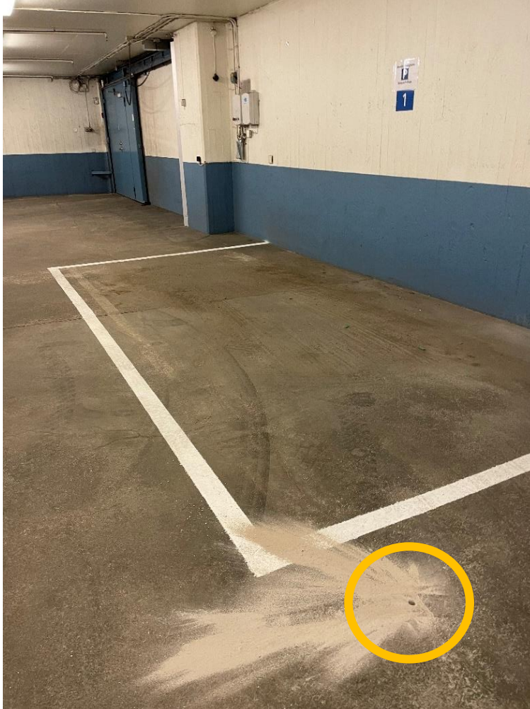
Figur 1. Provpunkt 23T01 placerades i parkeringsgaraget på källarplan 4. I foto ses uppborrat provtagningshål i betonggolvet, markerat med orange cirkel, föregående installation av provtagningsutrustning. Foto: Tyréns 2023-08-31
