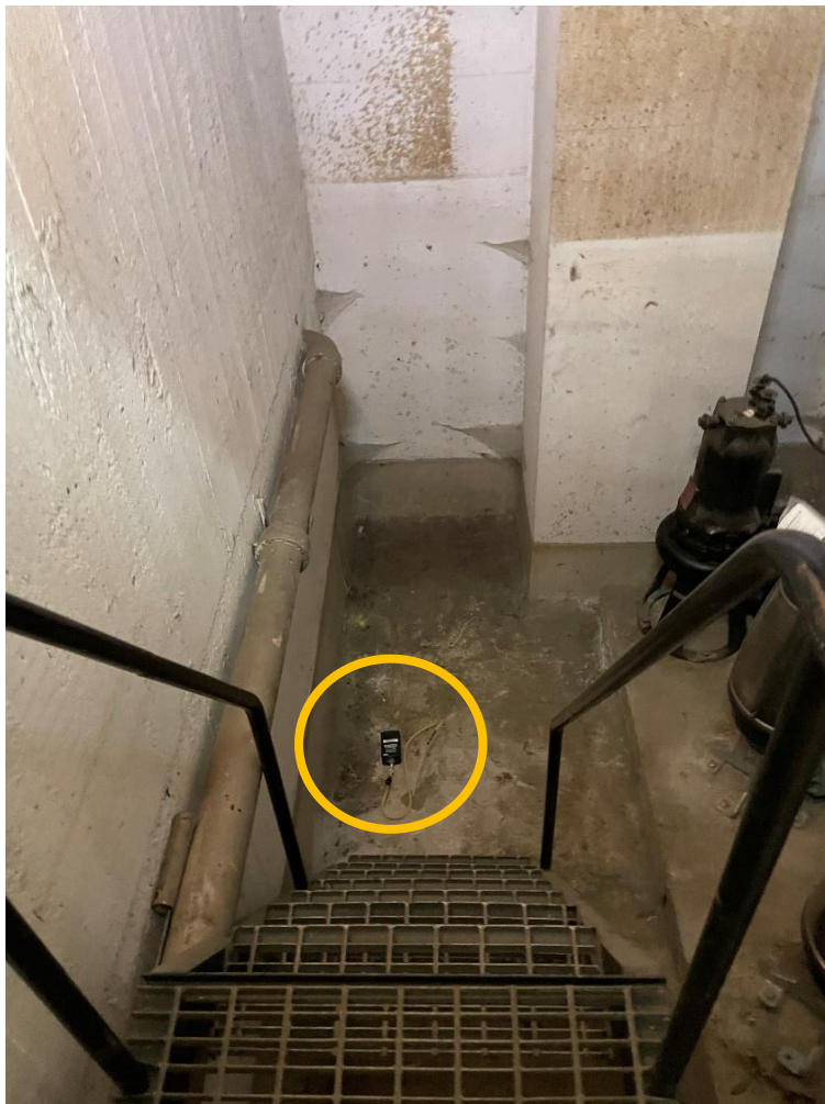
Figur 2. Provpunkt 23T02 placerades på källarplan 5 i rummet kallat pumpgrop. I fotot ses uppställd utrustning som använts vid mätning av porluft, utrustningen är markerad med orange cirkel. Foto: Tyréns 2023-08-31
