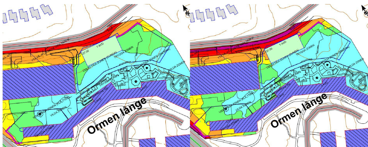
Bilden till vänster visar ekvivalent ljudnivå på förskolegårdarna mot Lagtingsgatan. Gränsen mellan blått och grönt går vid 50 dBA. Bilden till höger visar maximal ljudnivå. Gränsen mellan grönt och gult går vid 70 dBA. Sammantaget klarar stora delar av skolgården 50 dBA ekvivalent ljudnivå och 70 dBA maximal ljudnivå.
