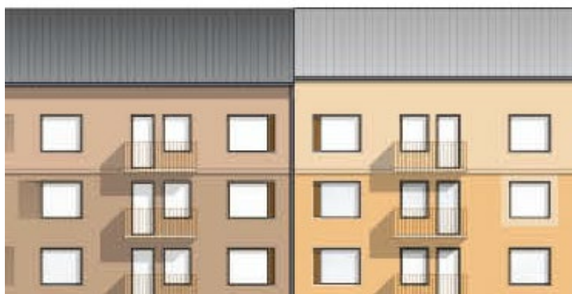
Illustration som visar variationen i utformning av takfot. Planbestämmelse ställer krav på regelbunden variation av takfoten för att accentuera skillnaden mellan trapphusen.
