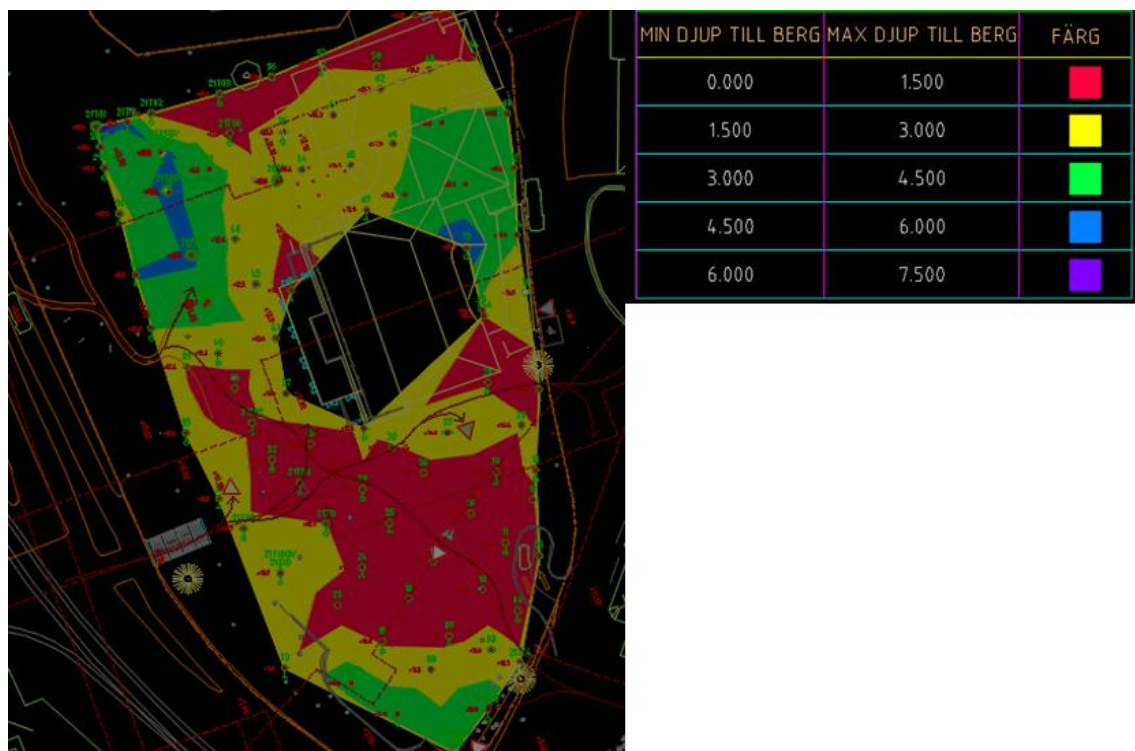
Figur 8. Djup till tolkad och interpolerad bergöverty från inmätt markyta i samband med inmätning av utförda borrhäls punkter.
