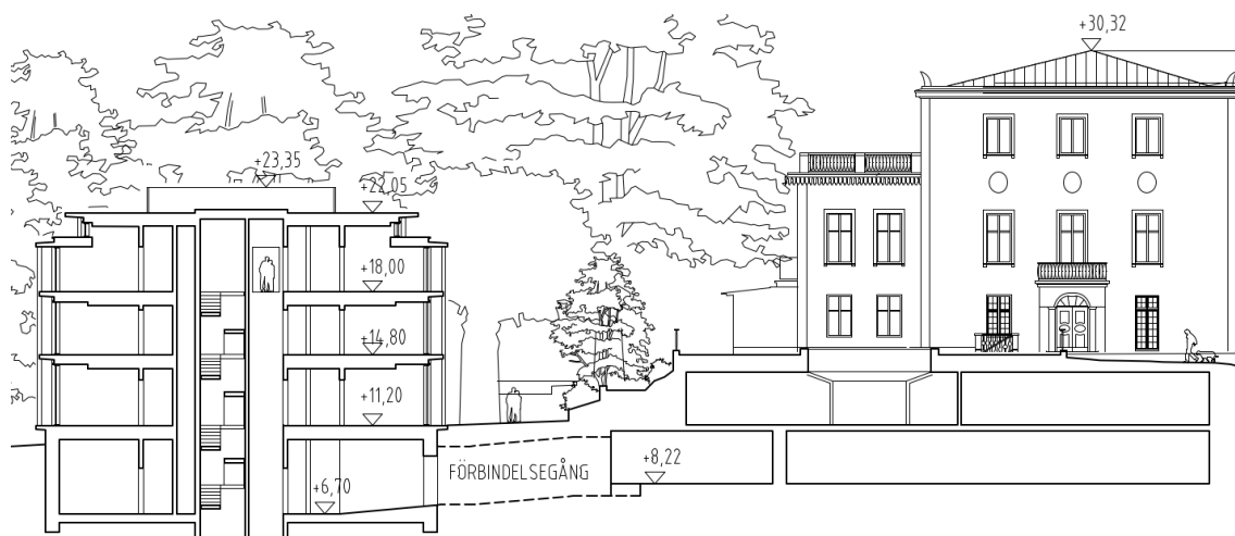
Figur 6. Sektion D-D som visar planerade tillbyggnader. Källa: Lundgaard & Tranberg Arkitekter A/S daterad 2023-10-06.
