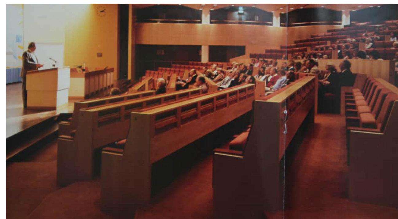
Essingesalen med plats för ca 450 personer. Salen var främst avsedd för konferenser men även teaterverksamhet. Taket är veckat för att ge bra akustik och för att ge plats åt installationer. Lärarnas hus, folder, 1986.
