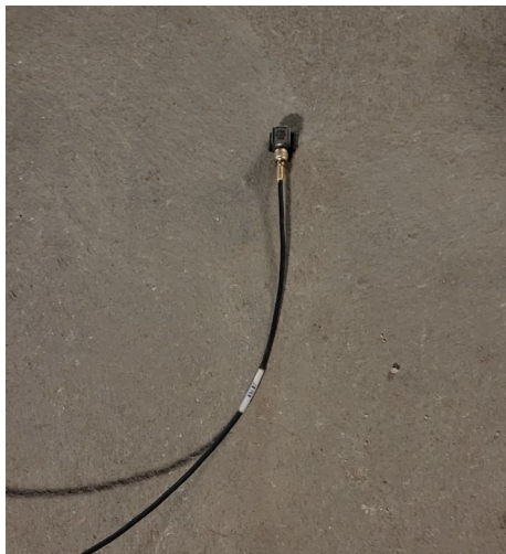
Figur 1 Accelerometer på bottenplatta i garage
