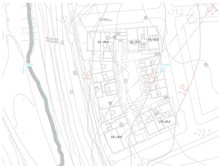
Figur 3. Bedömda jordlagerförhållanden inom kvarter H. Grå linje visar gräns mellan fastjord och lera, röda linjer visar bergsnivåer och grå moln visar berg i dagen eller på litet djup till berg.
