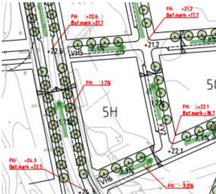
Figur 1. Kvarter 5H med befintliga och planerade gatunivåer
