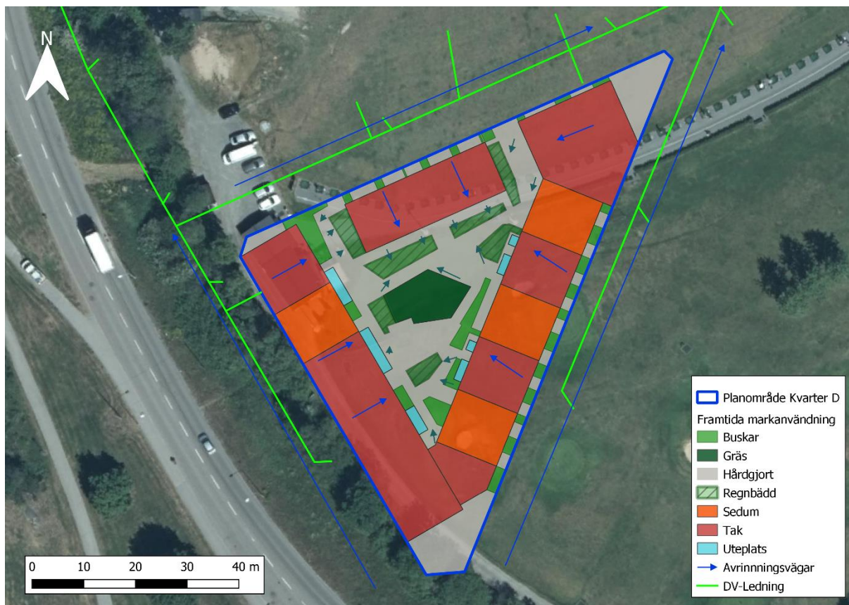
Figur 6-1. Principlösning för dagvattenhantering inom Kvarter D, Årstafältet.
