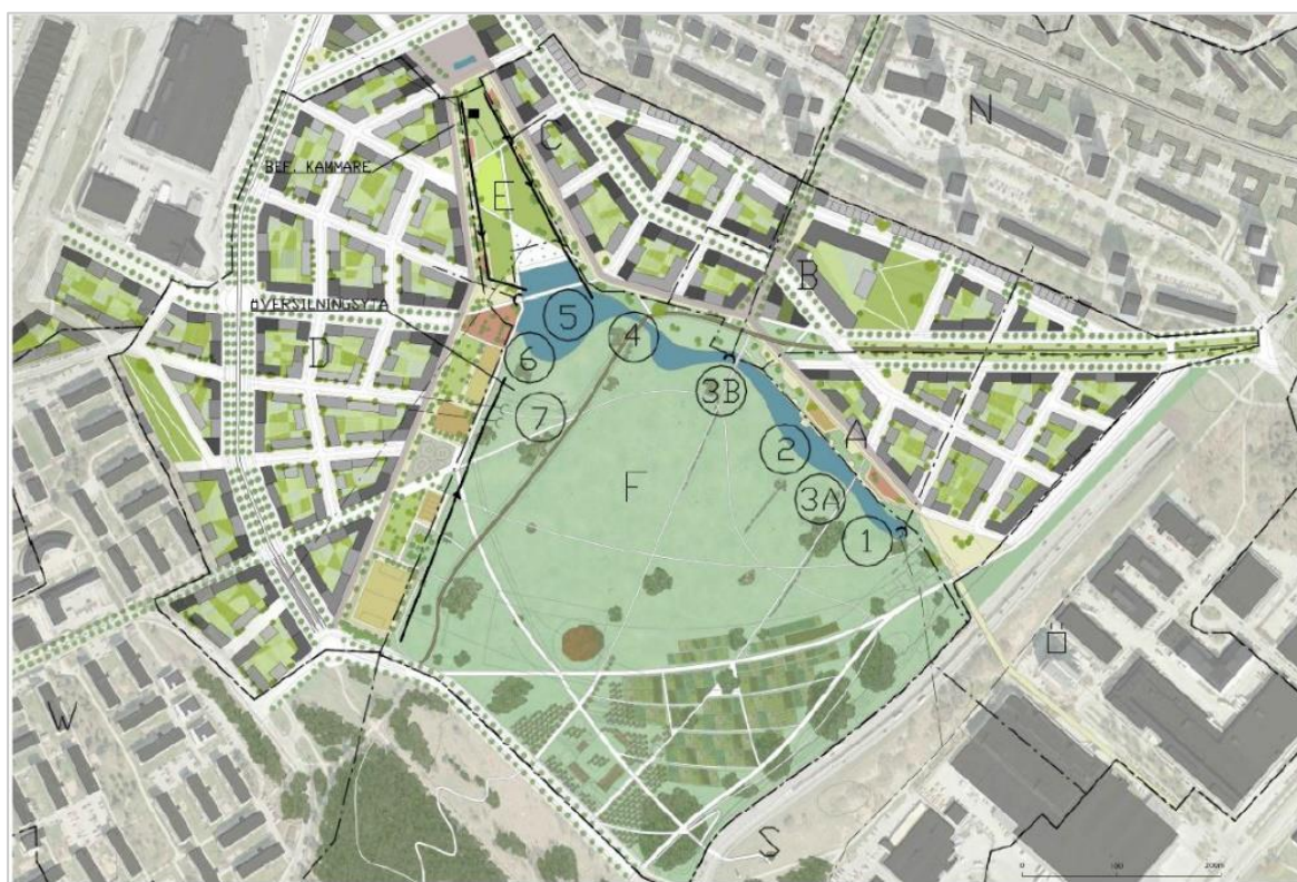
Figur 3-1. Avrinningsområden för planerad exploatering av Årstafälten. Planområdet Kvarter D innefattas av delavrinningsområdet D, där dagvatten leds mot Valla Å, vidare mot Valla damm (5). Figur från Sweco (2012).
