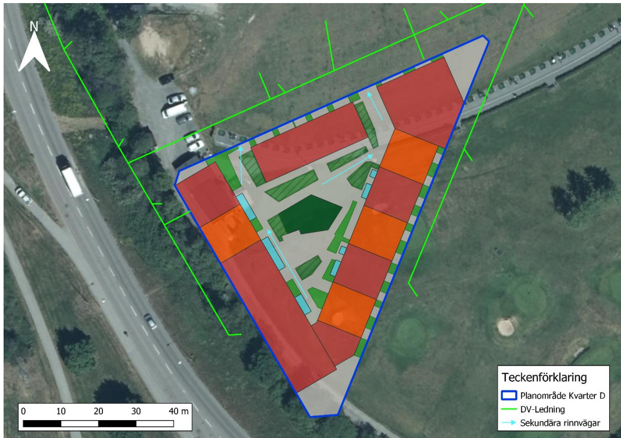
Figur 6-6. Sekundära avrinningsvägar för Kvarter D, Årstafältet.
