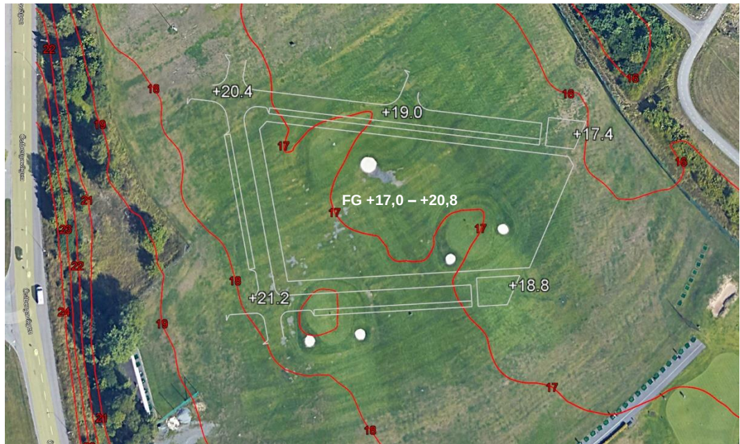
Figur 4. Satellitfoto över området i vy mot norr med befintliga marknivåkurvor redovisade med röda kurvlinjer. Vita nivåer är planerade gatunivå.
