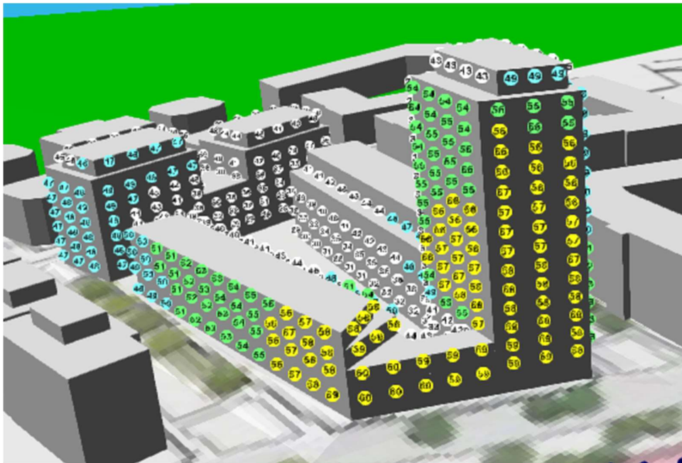
Figur 5 Skatepark flyttad 10 in mot Årstafältet. Dvs börjar 25 m från fasad i stället för 15 m. Ekvivalent ljudnivå vid fasad, dBA. Vy från sydöst. Upp mot 2 dB lägre ljudnivåer vid fasad.
