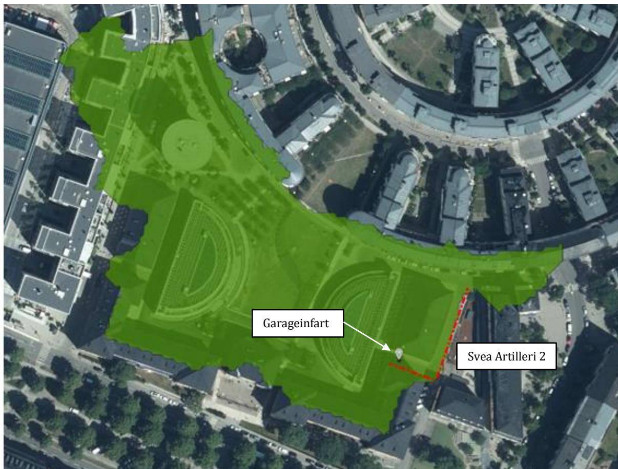
Bild 13, Tillrinning från nordväst, bedöms belasta parkeringsgarage på grannfastighet Svea Artilleri 14. Grå markering avser garageinfart, röstreckad linje avser kantsten som avgränsar flödet.
