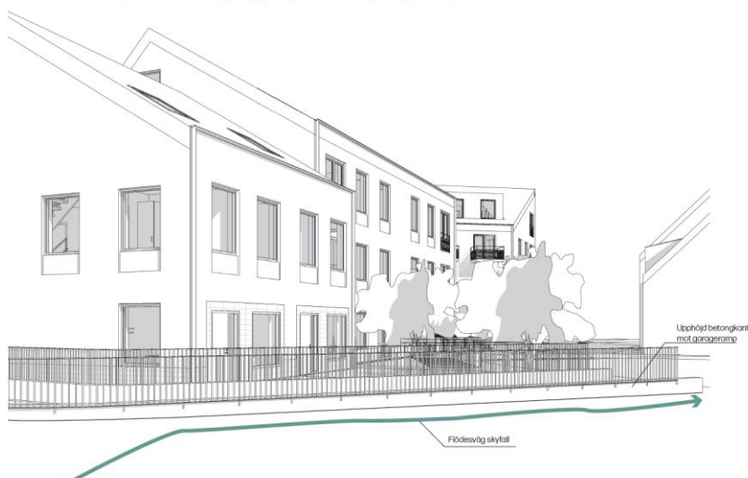
Vy B - Flödesväg vid skyfall längs upphöjd kant mot garageramp
